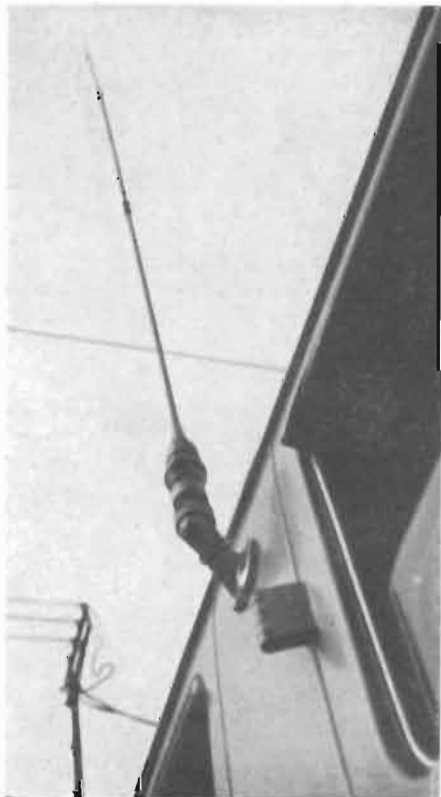
Fig. 4 - L'antenna e il suo attacco installati su una delle autoambulanze FIAT 1100/T in dotazione alla Ven. Arciconfraternita della Misericordia di Viareggio.
