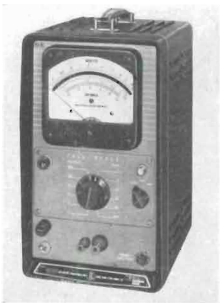
Un voltmetro che può trovare impiego quale indicatore di zero tra 5 Hz e 30 MHz e che può misurare tra 300 \mu V e 300 V tra 10 Hz e 11 MHz è presentato dai BALLANTINE LAB.S' Ulteriori notizie possono essere ottenute presso la agenzia italiana della SYLVAN GINSBURY LTD, Milano.
