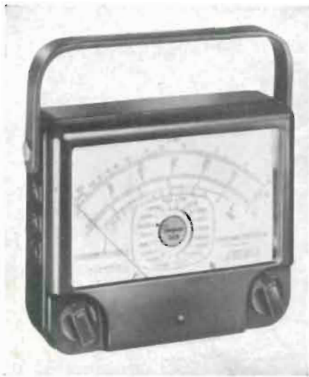
Alla ben nota serie di tester, la SIMPSON ELECTRIC Co. aggiunge ora due volt-ohm milliamperometri, modelli 267 e 268. Di essi il primo ha una scala 0 — 50 \mu A e il secondo 0 — 60 \mu A. Si differenziano infatti solo per la suddivisione delle scale che nel primo è per multipli di 2,5 e nel secondo per multipli di 3. Sensibilità 20 k \Omega /V in c.c. e 5k \Omega /V in c.a.; precisione del \pm 3% f.s.
